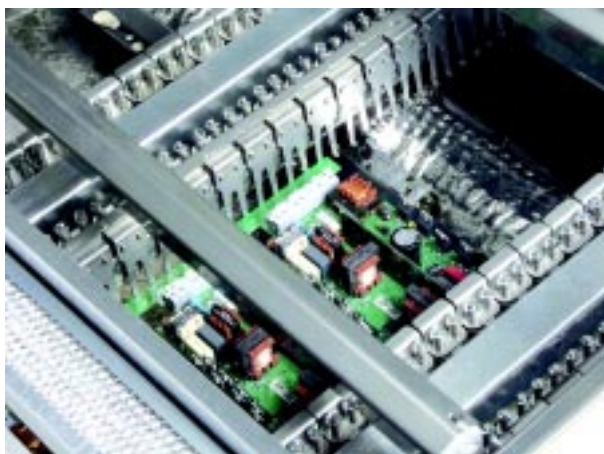
Tarjeta con componentes PTH enfrente de la ola.
